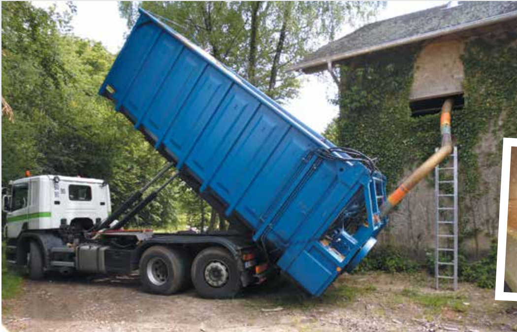
Les camions souffleurs de plaquettes permettent toutes les configurations de silos !
